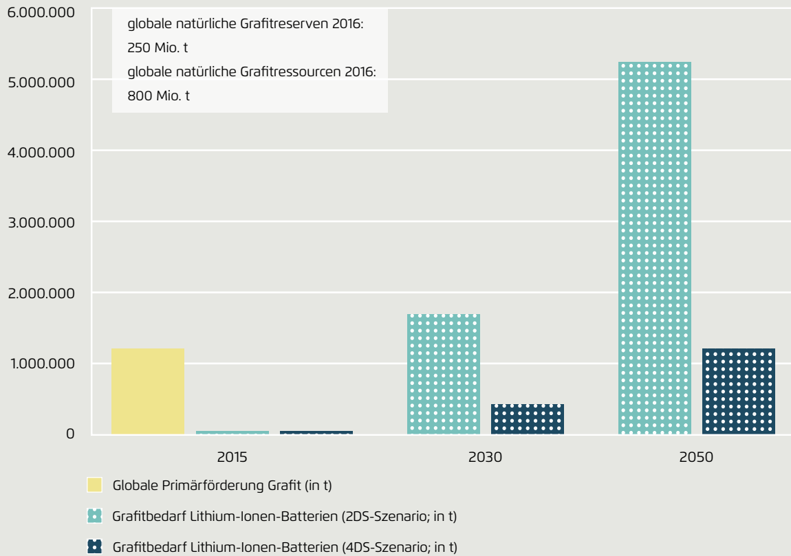
Globaler Grafitbedarf in Lithium-Ionen-Batterien für Fahrzeuge 2015, 2030, 2050 in den Szenarien 2DS und 4DS (in Tonnen)
